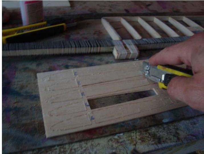
*Découpe des nervures au fur et à mesure*
