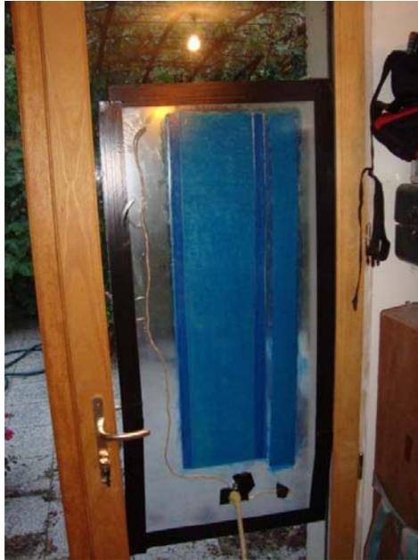
*Moulage de la peau du D-Box arrière sur une vitre. Une alternative sans risque si l'on n'oublie pas de passer du démoulant.*
