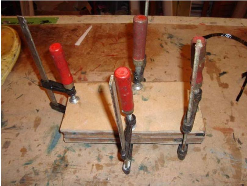
*Polymérisation sous presse. Attention à ne pas mettre un serre-joint au milieu. Cela déformerait le moule et le profil.*
