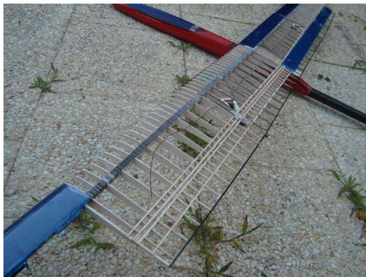
*La structure du panneau central monté. Au fond, sont posés les revêtements formant les différents D-box.*
