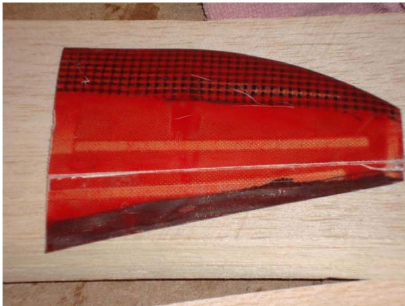
*Second essai. Cette fois ci, avec une résine colorée en rouge. Finalement, la couleur foncée passe mieux. L'articulation est à l'intrados. Un scotch posé d'un côté sur le volet et glissé sous la peau de l'autre, assure l'étanchéité. Noter la fente usinée sur les derniers centimètres du volet.*
