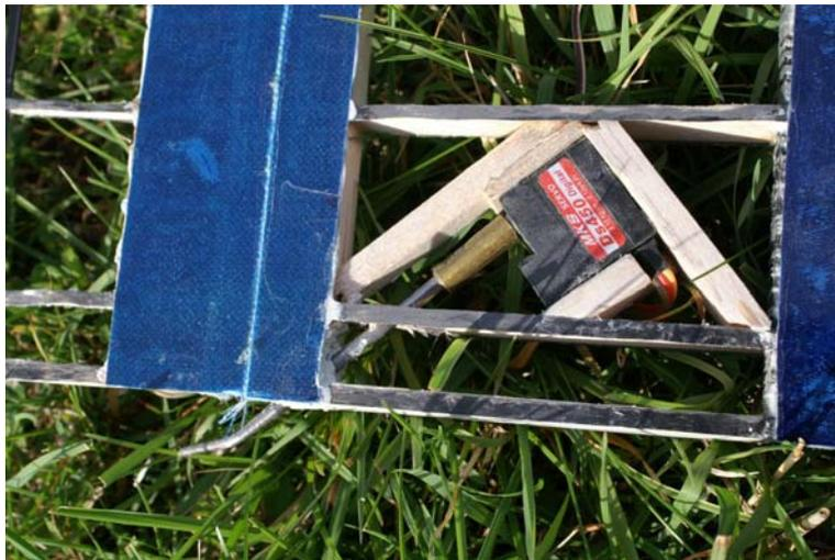
*Le servos est parfaitement immobiliser par un habillage en balsa. Le servos est collé à la cyanoacrylate. Deux plaques de balsa ou de composite (non encore montés sur la photo) finalisent le dispositif.*
