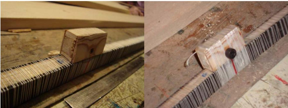
*Le bloc servant à immobiliser l'aile sur le fuselage est collé sur le longeron principal. Puis solidifié avec une belle ligature en fil de pêche « aramide » tressé.*
