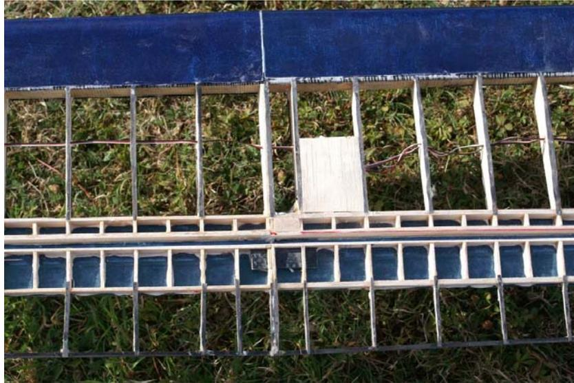
*Il reste encore à coller la peau supérieure du D-Box arrière pour terminer l'aile. Remarquez qu'il y a trop de résine sur le D-box arrière. Heureusement, il n'y a pas de coulure dans la partie « articulation ». On voit bien la poche de commande du système RDS.*
