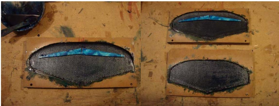
*La stratification faite. Remarquez la résine teintée en bleu foncée, le lé de Kevlar / Carbone dessus le BF, et le BA roulé dans chaque 1/2 moule. Remarquez aussi les deux piétages qui vont permettre de bien aligner les deux 1/2 moules.*
